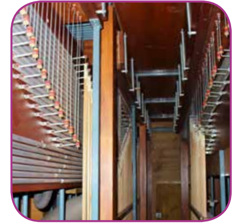
4 Mechanische Spieltraktur – Verbindung von der Taste zur Windlade
