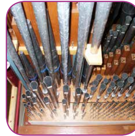
7 Pfeifen auf der Windlade des unteren Manuals, mit offenen und gedeckten Pfeifen
